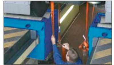
Gewichtssimulator MLS 2100 / 2200 Zweifach-HD-Zylinder zur festen oder beweglichen (auf Schienen) Bodenmontage.
