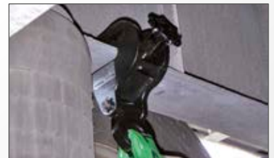
Befestigungsklemmen Zur Befestigung der Gurte am Fahrzeugrahmen.
