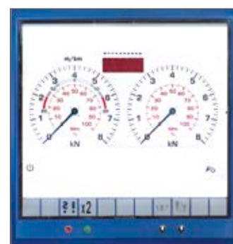
Multi-Analoganzeige Übersichtliche Darstellung auf deutlich ablesbaren Zeigerinstrumenten
